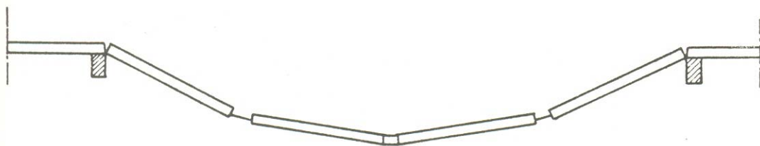
Figur 8.13 Linverkan i bärverksstrimla efter stödbortfall. Bärverksdelarna hänger i förbindningsarmeringen samt ordinarie längsgående armering [1]
