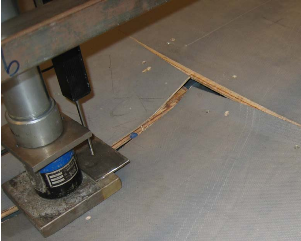
Bild 2 Brott har uppstått i samtliga skarvar i närheten av punktlasten (lasten överstiger 25 kN).
