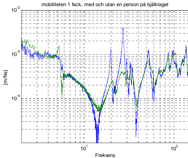
Figur 9.2 Den övre kurvan är samma som i Figur 9.1 och den lägre kurvan representerar fallet då en person befinner sig på bjälklaget.
