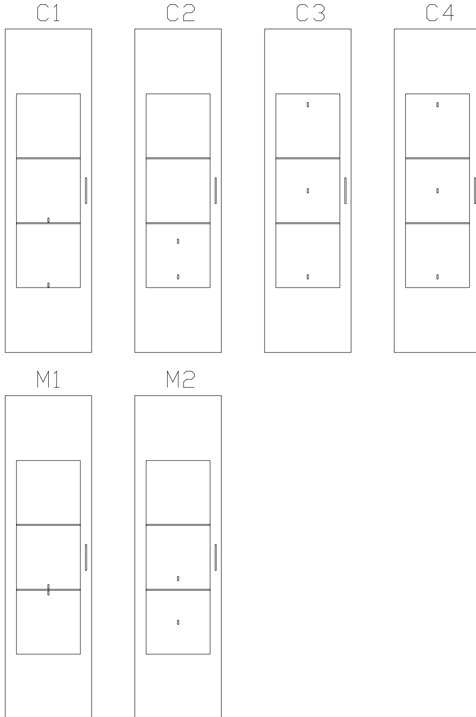
Figur 6-4. Placering av töjningsgivare för provkropparna, □ = töjningsgivare
