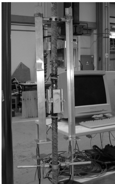
Figur 4.10 Försöksuppställning vid provdragning av armeringsjärn.
