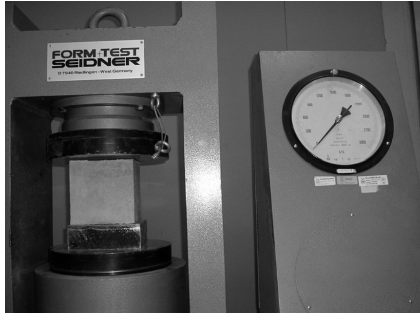
Figur 4.3 Försöksupställning för bestämning av tryckhållfasthet
