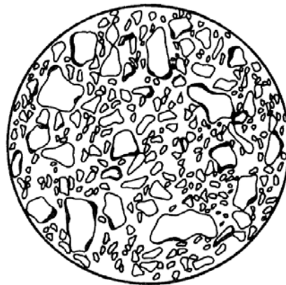
Figur 2.2 De mörkare partierna visar exempel på mikrosprickor. Källa: Ljungkrantz et al. 1994
