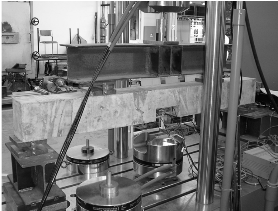
Figur 4.9 Försökupställning vid böjprovning av balkar
