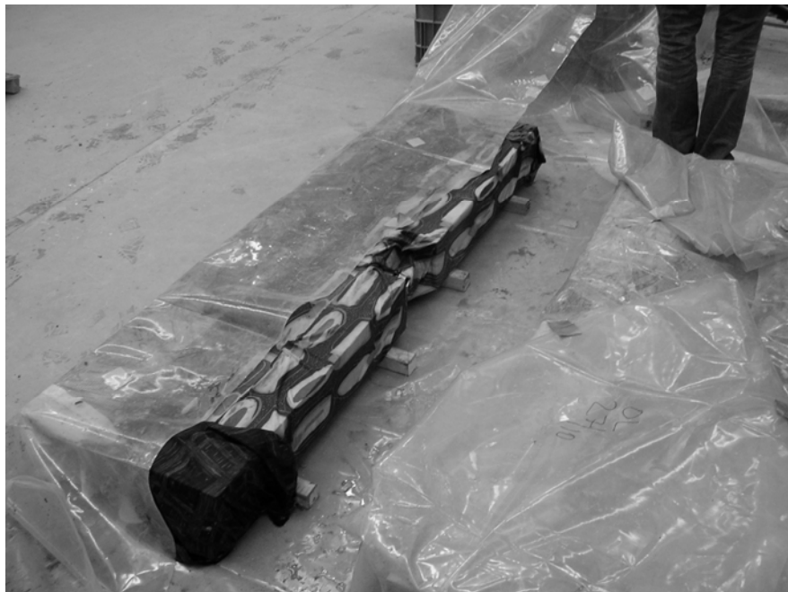
Figur 4.4 Balkarna täcks med våta trasor och plastas in för förvaring.
