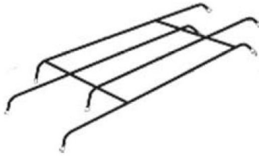
Figur 3.7 Armeringsnät för överkant i bjälklag (Celsa Steel Service, 2008)
