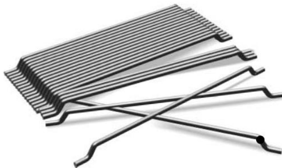
Figur 3.10 Vanlig stålfiber för inblandning i betong (Bekaert, 2008)
