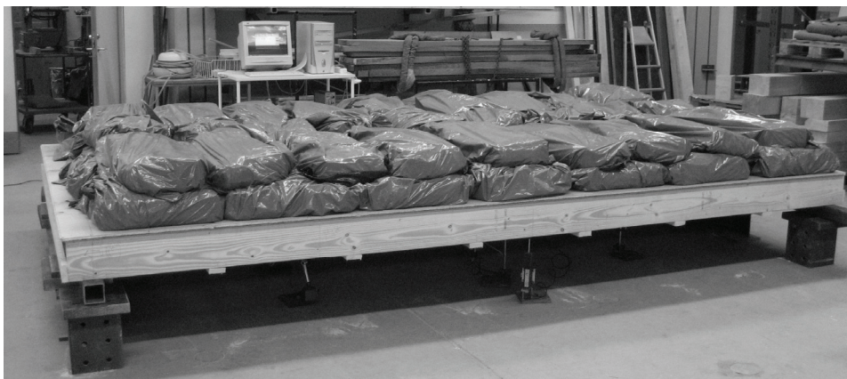
Figur 5 Foto på referensbjälklag belastat med cementsäckar.
