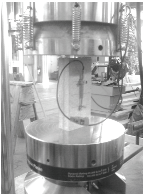
Figur 12 Foto på tryckförsöksupställning
