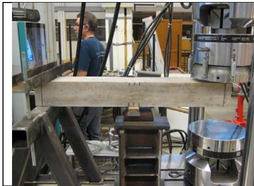
Figur 5.5 Tryckning av balk i MTS-maskin.
