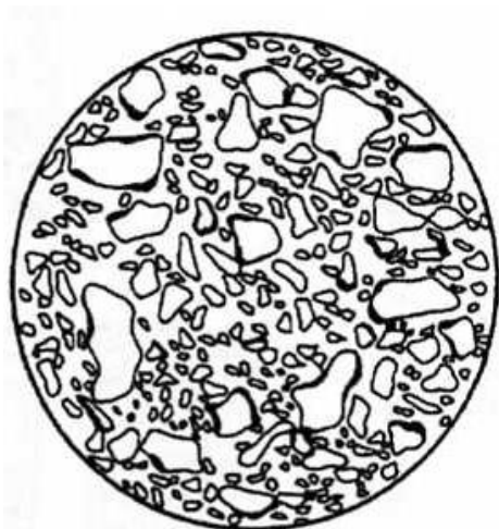
Figur 3.1 Mikrosprickor i betong. Källa: Ljungkrantz 1994
