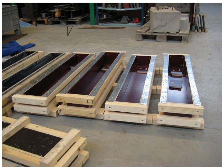
Figur 5.2 Träformar för tillverkning av provkroppar.
