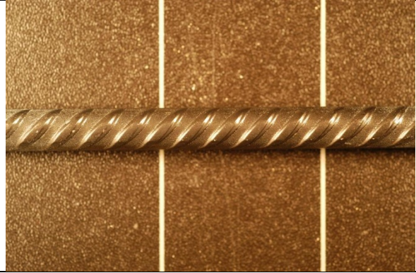
26-2 Korrosionsangrepp på järn 2 i balk 26 med täcksikt c=40 mm, stålspanning 0 MPa och diameter 8 mm, kloridbelastning ovanifrån, gradering 1.
