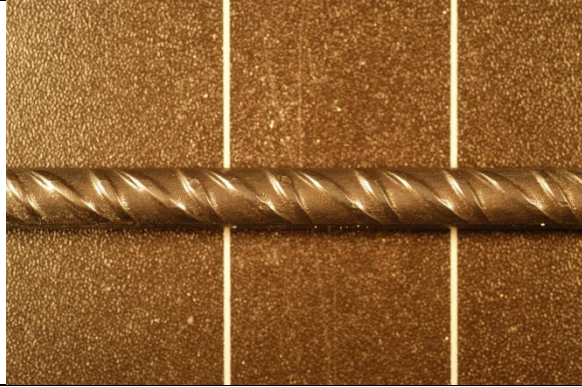
26-1 Korrosionsangrepp på järn 1 i balk 26 med täcksikt c=40 mm, stålspanning 0 MPa och diameter 8 mm, kloridbelastning ovanifrån, gradering 1.
