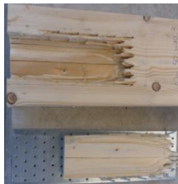
Figur 2: Vänster bild: Typiskt klossbrott. Höger bild: Spikarnas utseende vid spikbrott.
