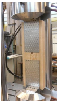
Figur 3: Försökupställning för spikplåtsförbanden. Figur 4: Exempel på olika spikmönster som användes i försöksprogrammet.
