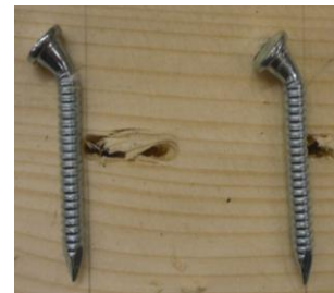
Figur 2: Vänster bild: Typiskt klossbrott. Höger bild: Spikarnas utseende vid spikbrott.
