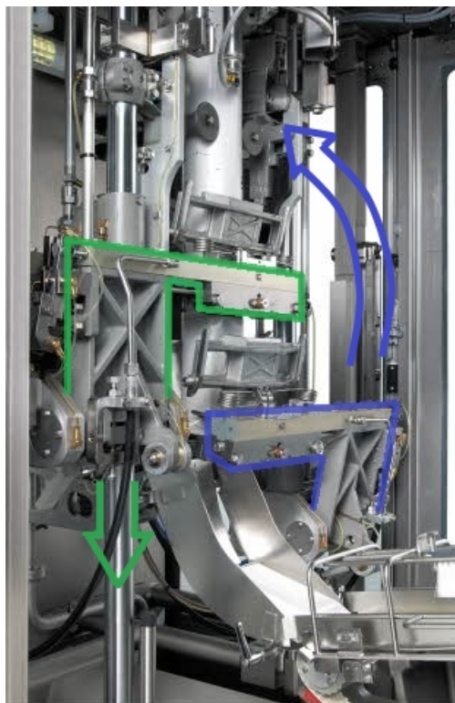
Figur 1.3: Förseglingsdelen av en A3/Flex. De gröna och blåa markeringarna visar de två identiska armar på vilka induktorerna är placerade samt deras rörelseriktning. Källa: Tetra Paks bildbank.
