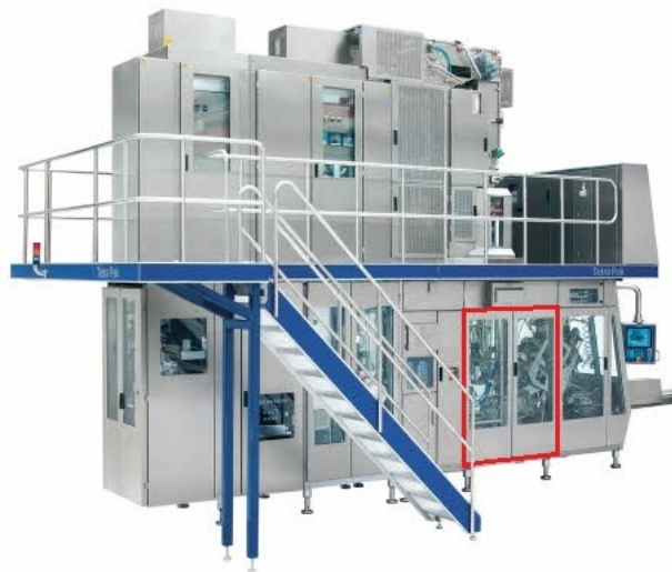
Figur 1.1: En Tetra Pak A3/Flex. Bakom de rödmarkerade dörrarna befinner sig förseglingsutrustningen. Källa: Tetra Paks bildbank.
