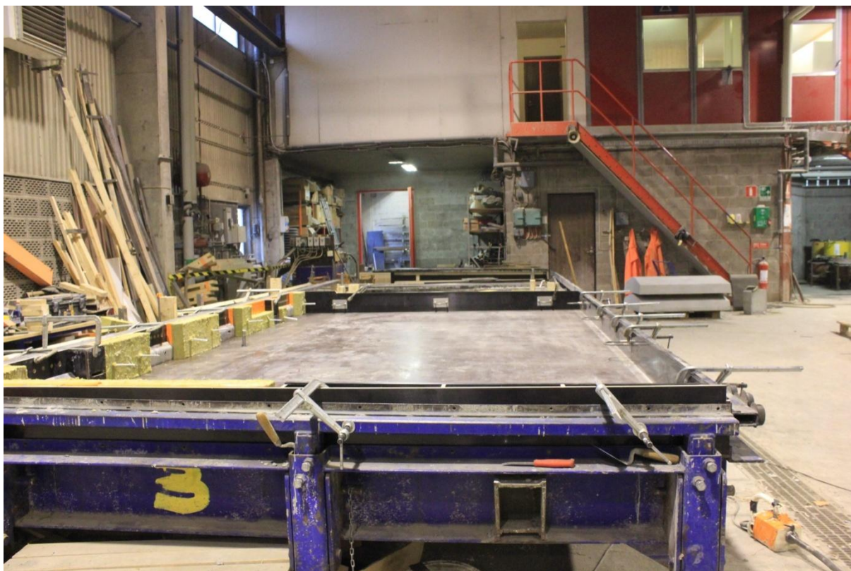
Figur 12: Gjutbädden som används hos Skandinaviska byggelement, Bjästa. Foto: Sayle Shamun
