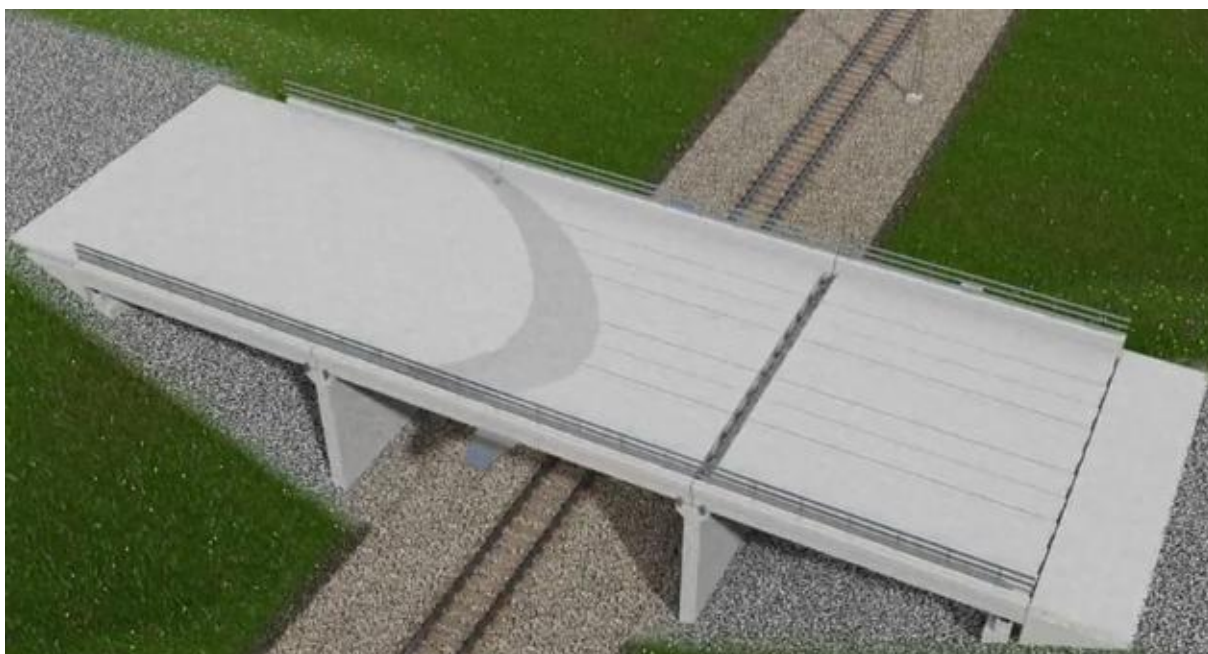
Figur 4: Gjutning av balkar, ändskärmar, vingar och brobana (NCC, 2012).
