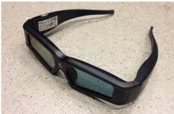
Figur 8. Slutartidsstyrda 3D-glasögon för aktiv stereoskopi.
