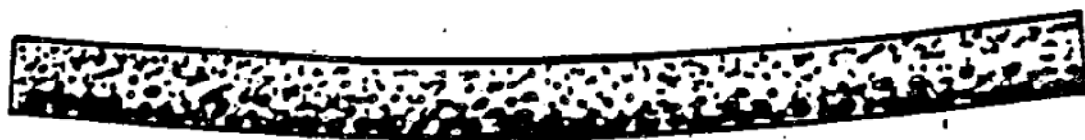
Figur 13 - Genom separation uppstår buktning av betongskivorna (Haeussler 1980).
