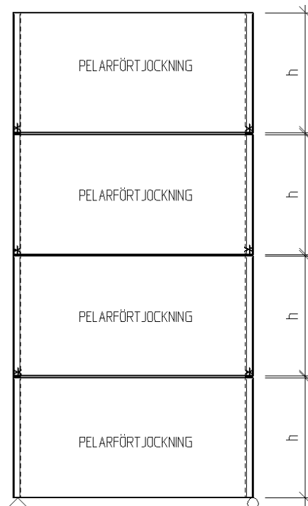
Figur 55 - Element med pelarförtjockning pallas under förtjockningen.
