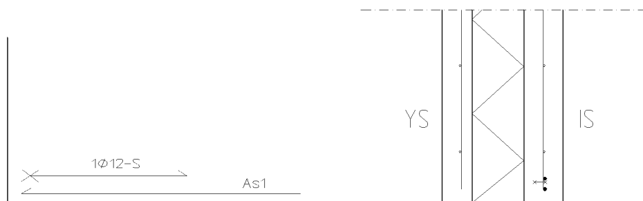
Figur 31 - Det nedersta elementet armeras med en S-bygel i underkant. a) s-bygelns placering i hörnet på elementet, b) s-bygelns placering i ett snitt genom väggen.
