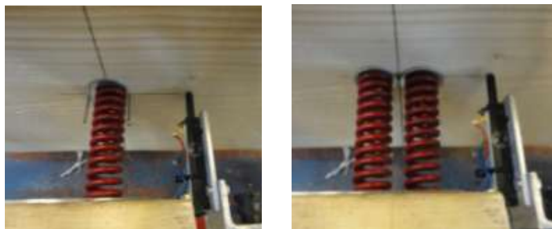
Figur 7.4. Fjädrarnas placering vid en respektive två verksamma fjädrar placerad i balkens mitt
