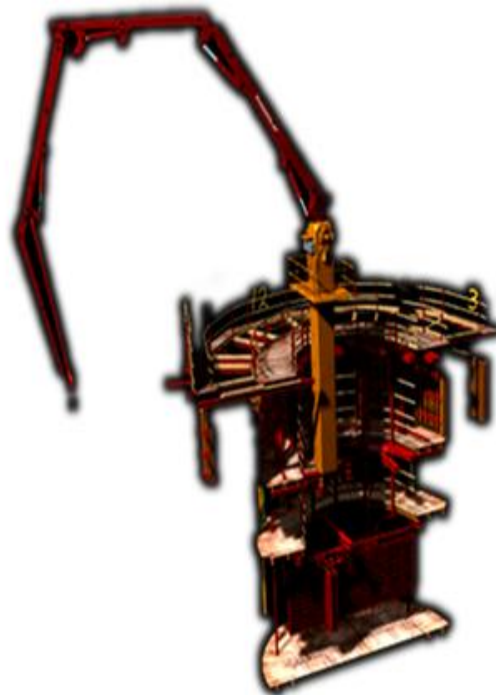
Figur 14 Klätterformen som användes vid Turning Torso
