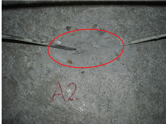
Figur 2.5 Brottkon för dragprov A2, den röda ellipsen anger varifrån radierna har blivit uppmätta.
