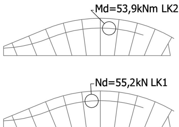
Figur 8.10 Beskrivning av var värsta belastningsfall inträffar för den lägre byggnadsdelens fasader.
