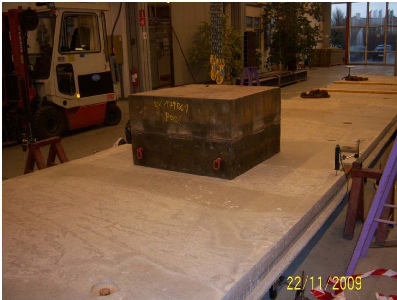
Figur 4-4 visar försökets uppställning där plattan belastas i 10 dygn
