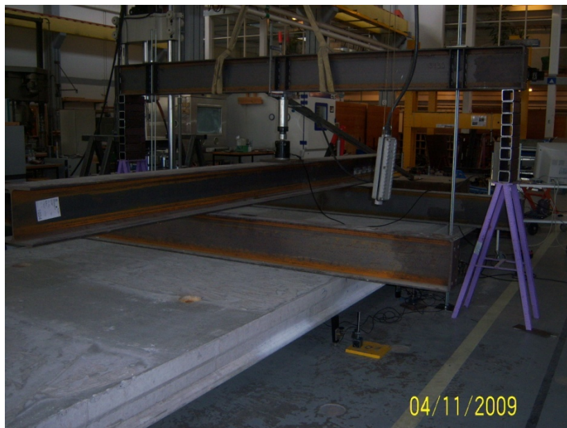
Figur 4-2 Uppställning av platta i laboratorium
