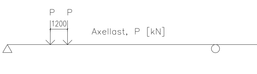
Figur 7.4 Placering av axellaster i längdled enligt Eurocode.
