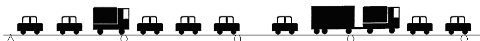
Figur 5.4 En kö som består av blandat lätta och tunga fordon. (Bilder på bilarna är hämtad från Svensson (1997))
