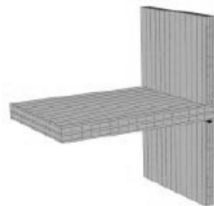
Figur 5.19 Massiva väggar och bjälklag (Massivträ Handboken, 2006)
