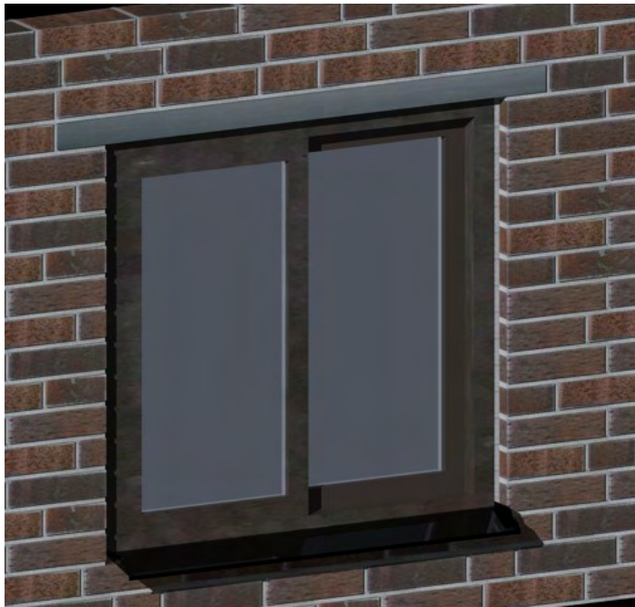
Figur 4.9a Fönster med varmgalvaniserad stål balk av liggande vkr-profil (120x60x5 mm).
