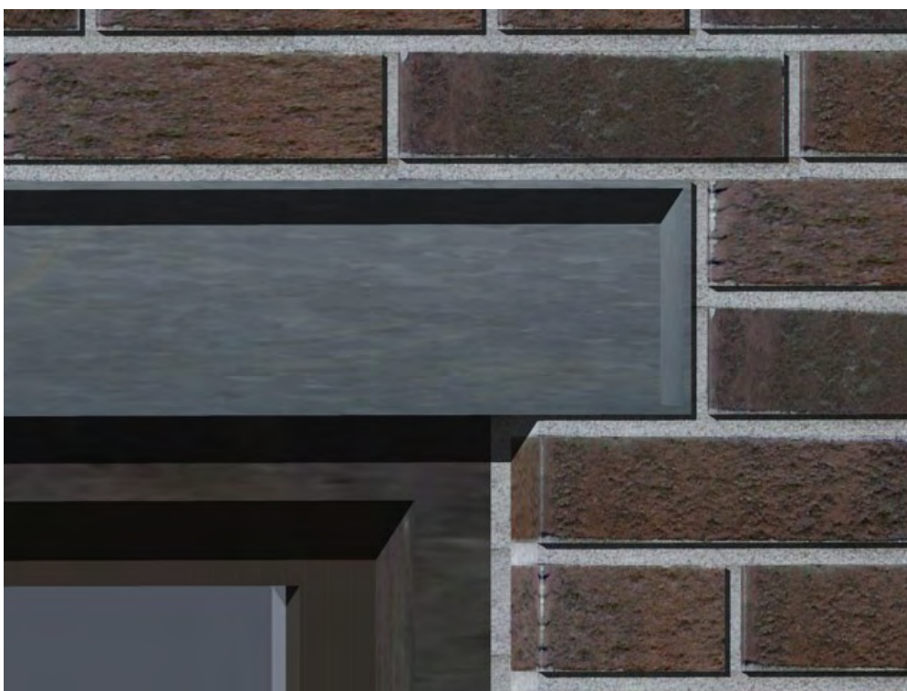
Bild 4.10e Fönsterhörn med balk av vkr-profil (120x60x5 mm) med påsvetsad plattstång med dimensionen 120x5 mm av rostig yta.
