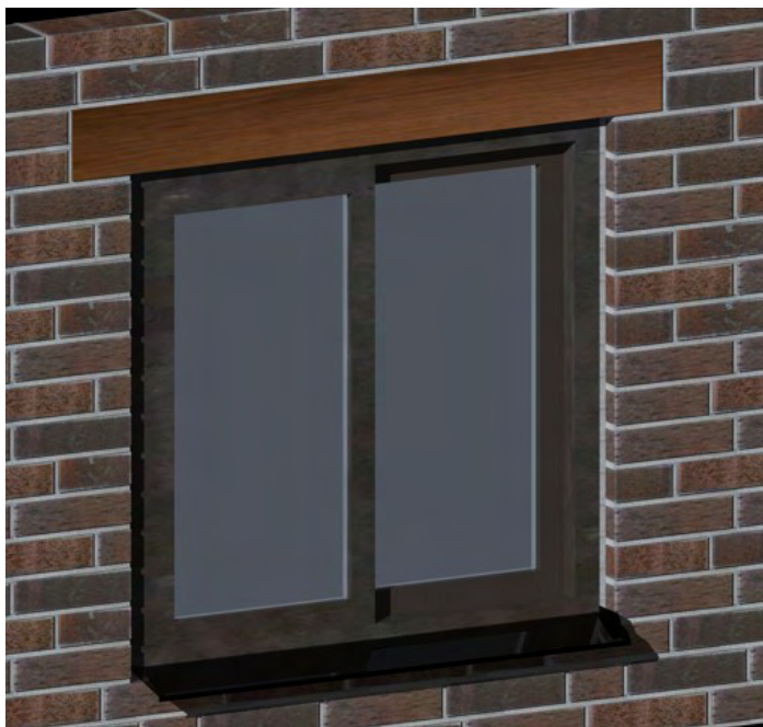
Figur 4.9c Fönster med ekträbalk, två tegelskift hög.
