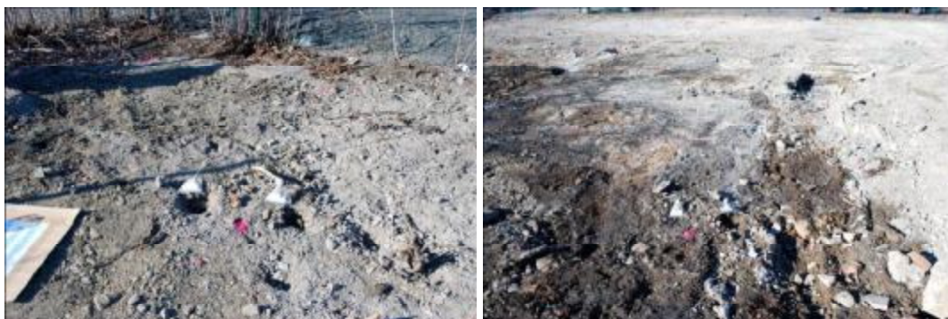
Figur 12. Den vänstra bilden visar det sydvästra hörnet i 20*20 metersrutan där provpåsarerna från den konventionella rutnätsprovtagningen ligger. Bilden till höger visar provpunkterna i den nordöstra delen av rutan, där färgskiftningarna i materialet var tydliga. Provpåsarerna markerar provpunkternas lägen.
