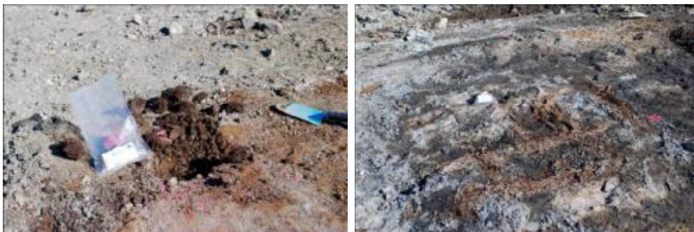
Figur 13. Fotot till vänster visar en provpunkt i den slumpartade provtagningsstrategin. Materialet i området skiftade i färg och det var tydligt utfyllt med bland annat slagg. Bilden till höger visar den slumpmässiga placeringen av en provpunkt invid en ruten träkonstruktion.
