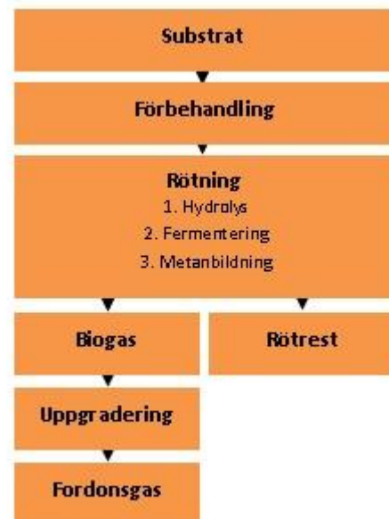
Figur 3 Från råvara (substrat) till färdig biogas eller fordonsgas går processen i flera steg.
