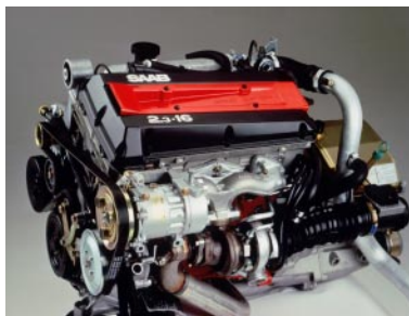
Figur 6.2: Verklig utformning av en bilmotor till Saab.
