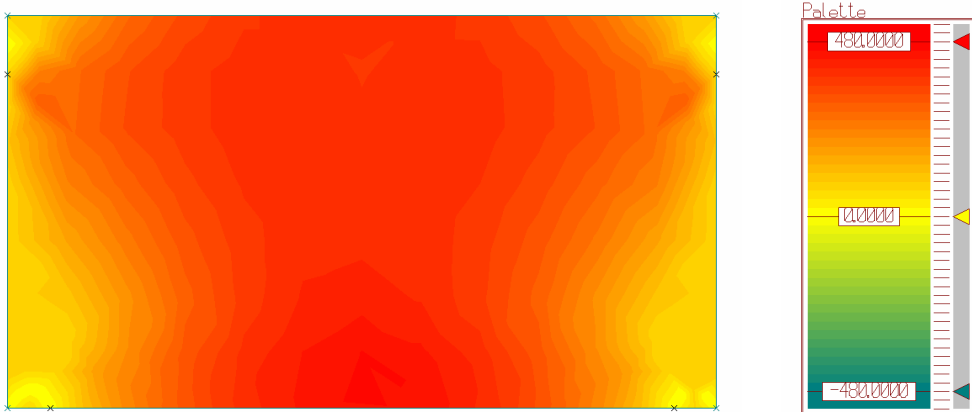
Figur 19 Visar FEM-beräkning på erforderad armeringsmängd i botten av plattan och i x-led. Lastfallet är i Kiruna och enheten är \text{mm}^2/\text{m} . Fasaden ligger mot figurens nedre horisontella kant.
