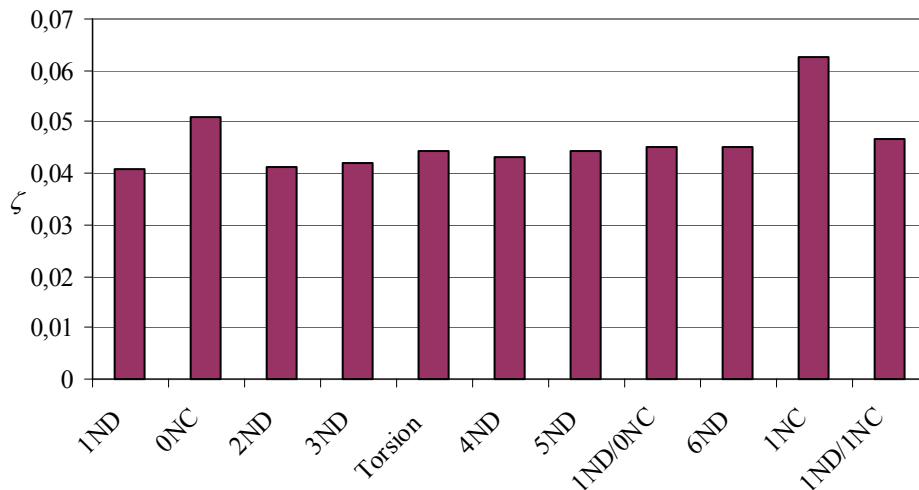
Figur 5.15 Modala materialdämpningsförhållanden i bliskmodellen, baserat på materialdämpningsparametrar enligt [13].
