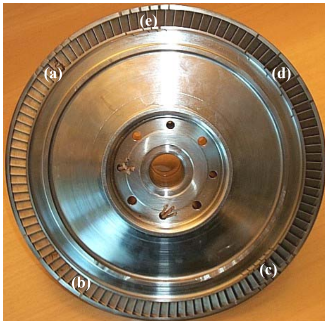
Figur 6.1 Vulcainblisken i testutförande. I bilden indikeras de positioner (a-e) kring blisken vid vilka geometrin modifierats.
