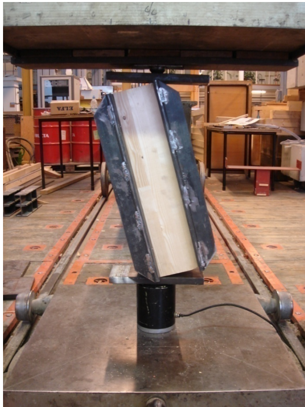
Figur 24: Uppställning EN408- skruv.
