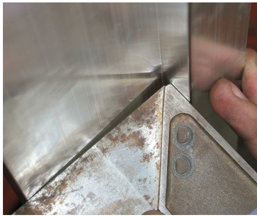
Figur 4.15: Livvippning på profiltyp E.
