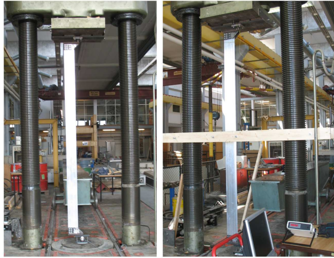
Figur 4.5: Provuppställningar utan sidostabilisering till vänster (3x3m) och med sidostabilisering till höger (3x1,5m).
