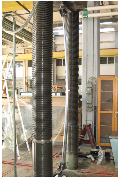
Figur 4.9: Knäckning av profiltyp A utan sidostabilisering.
