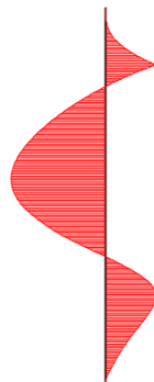
Figur 4.13. Momentkurva för spontprofil med förutsättningar enligt Sponthandbokens dimensioneringsmetod.
