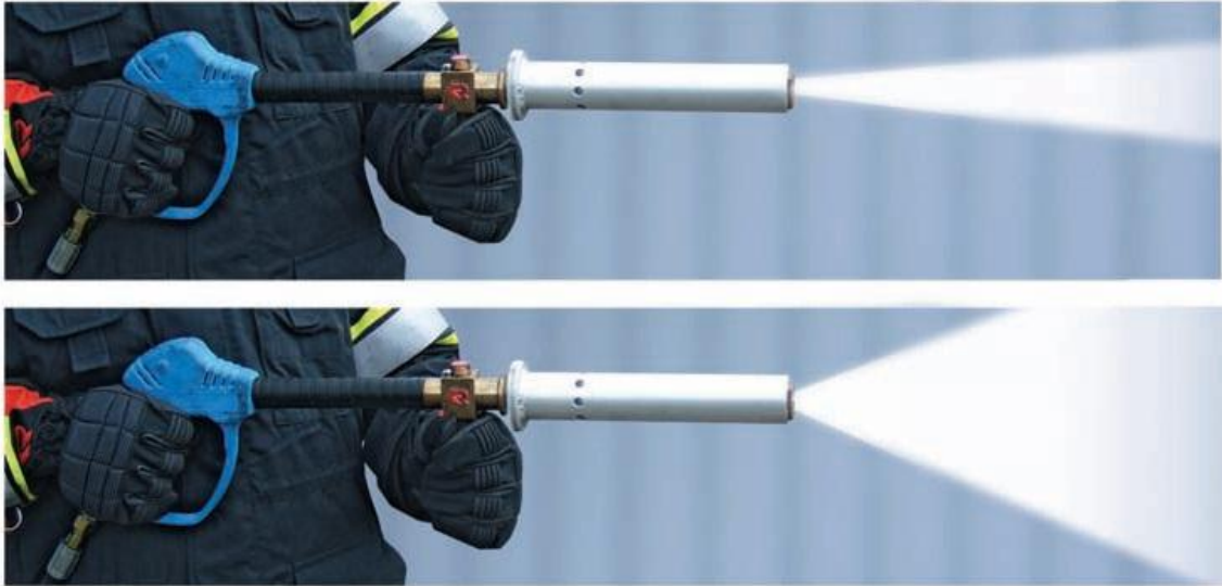
Figur 3.5. Exempel på strålbildens utseende vid högtrycksbrandsläckning. Droppstorleksfördelningen är mycket liten. Överst används en sluten och nederst en spriden stråle (med tillåtelse från Rosenbauer).
