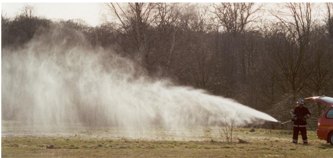
Figur 3.7. Firexpress strålbild med vatten och 23 bar vid munstycket (med tillåtelse från Firexpress).
