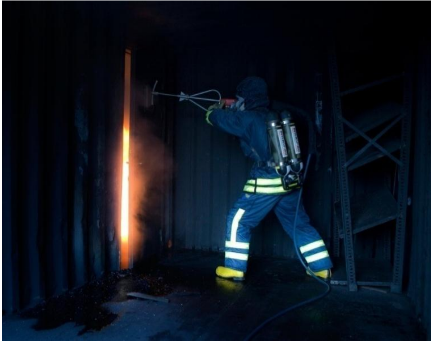
Figur 3.9. Skärsläckaren forcerar en dörr samtidigt som operatören står skyddad (med tillåtelse från ColdCut Systems).
