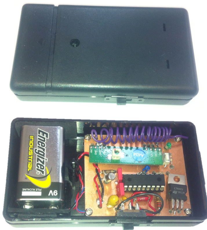
Bild 28: Inkapsling av mottagarkretskortet och batteri. [62]
