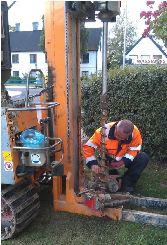
Figur 5. Markprovtagning genom skruvborrning med borrhandsvagn. Foto: Hanna Lindvall, Tyréns AB
