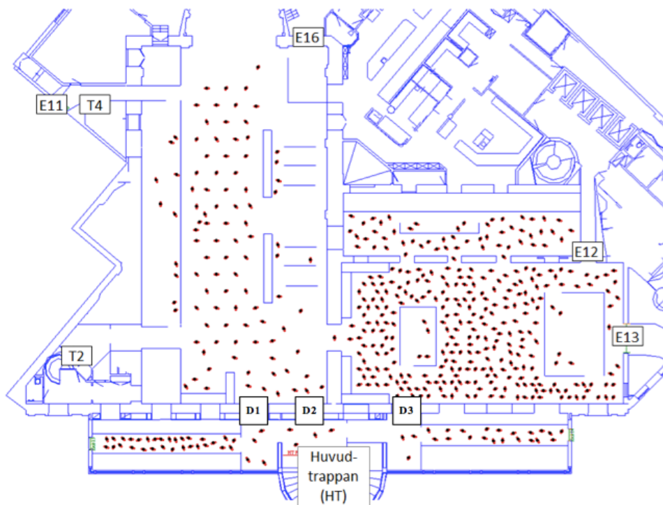
Figur A.2. Utrymningsvägarna i källarplan markerade med E och trapporna med T. D1-D3 markerar de dörrar som tas med i handberäkningarna.
