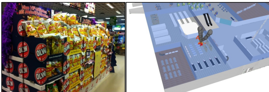
Figur 8.1. Till vänster ses scenario A:s brandbelastning som utgörs av 90 lådor med chips/ostbågar och till höger ses brandens placering i varuhuset.
