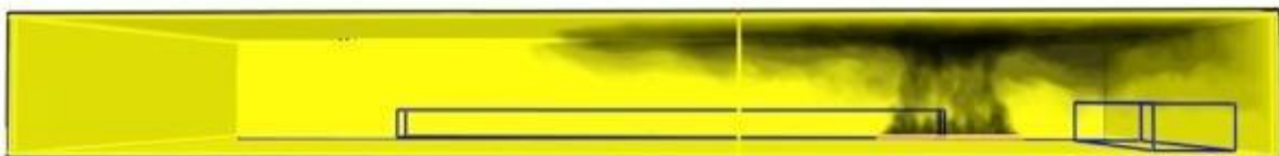
Figur 88. Åskådliggör förhållandena i Lilla ishallen då FDS anser att ett brandgaslager börjat bildas. Som synes täcker brandgaslagret inte hela taket ännu.
