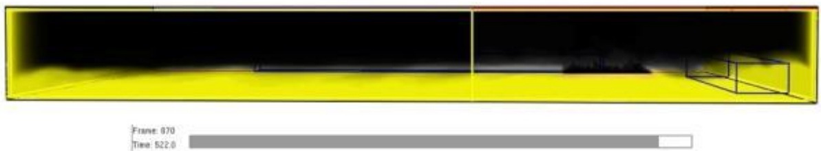
Figur 101. Brandgasfyllnad 520 sekunder efter brandstart.
