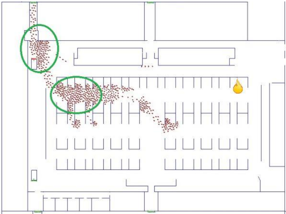
Figur 113. Situationen i Lilla ishallen 80 sekunder efter att branden startade i scenariot Brand under mässa. Vid den här tidpunkten uppstår köbildning vid den första utrymningsvägen och bland montrarna.
