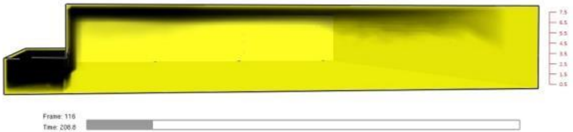
Figur 79. Åskådliggör förhållandena cirka 200 sekunder efter att branden startade. Vid den här tidpunkten skulle kritiska förhållanden kunna ha uppstått för de på de översta läktarplatserna på grund av att brandgaslagret sjunkit så lågt, enligt FDS-simuleringen.
