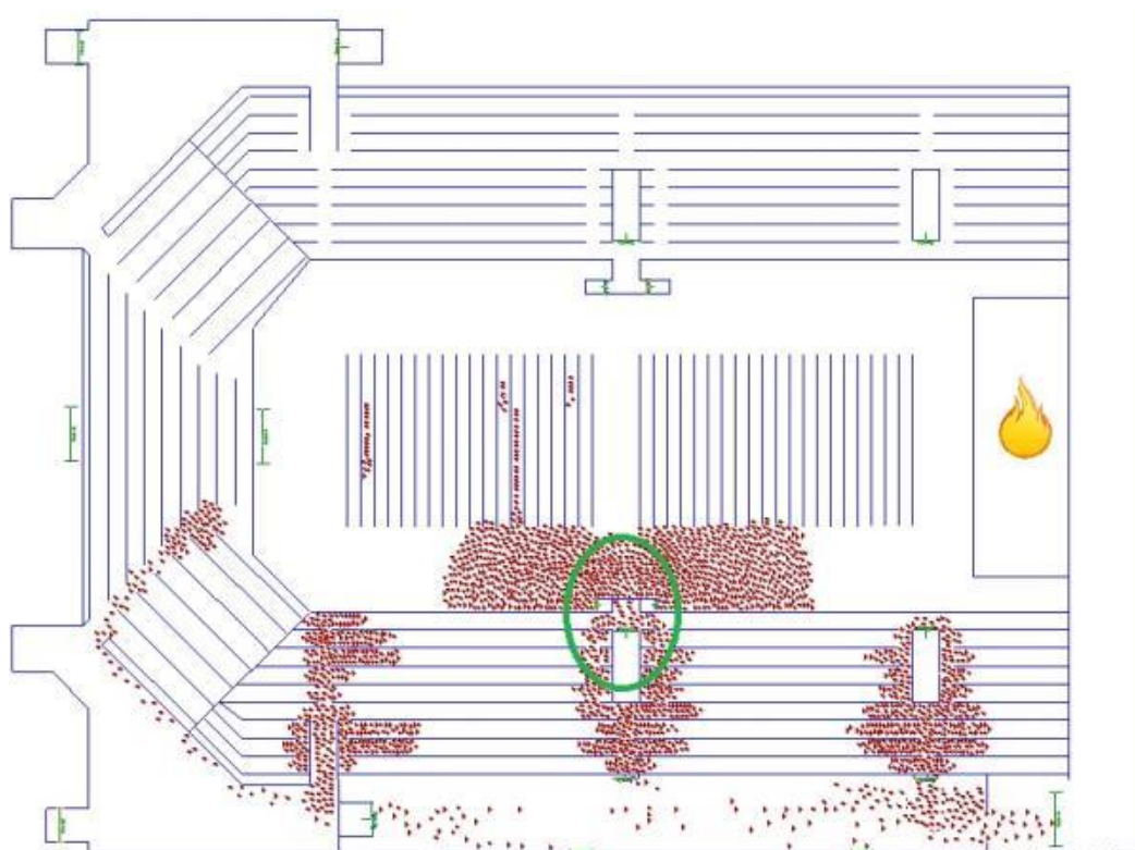
Figur 118. Situationen i Stora ishallens övre läktare vid scenariot Brand under konsert. Känslig plats ur utrymningssynpunkt är markerad.
