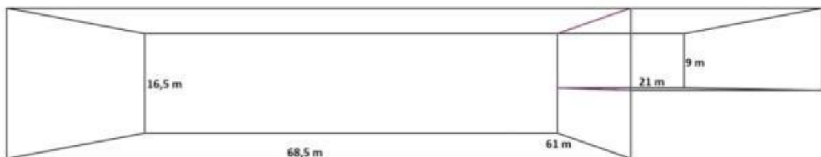
Figur 123. Visar geometrin sådan som den approximerades till i CFAST.
