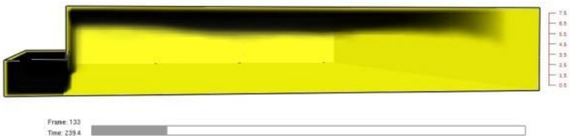
Figur 80. Åskådliggör förhållandena cirka 240 sekunder efter att branden startade. Vid den här tidpunkten har brandgaslagret tillfälligt stabiliserats.
