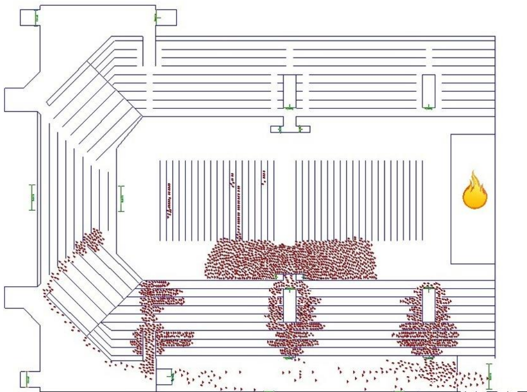
Figur 55. Bild tagen från Simulex-simulering i Stora ishallen vid tidpunkten då kritiska förhållanden beräknas uppstå för personerna på översta läktarplatserna. Som synes skulle inte en säker utrymningssituation vara möjlig enligt simuleringarna.
