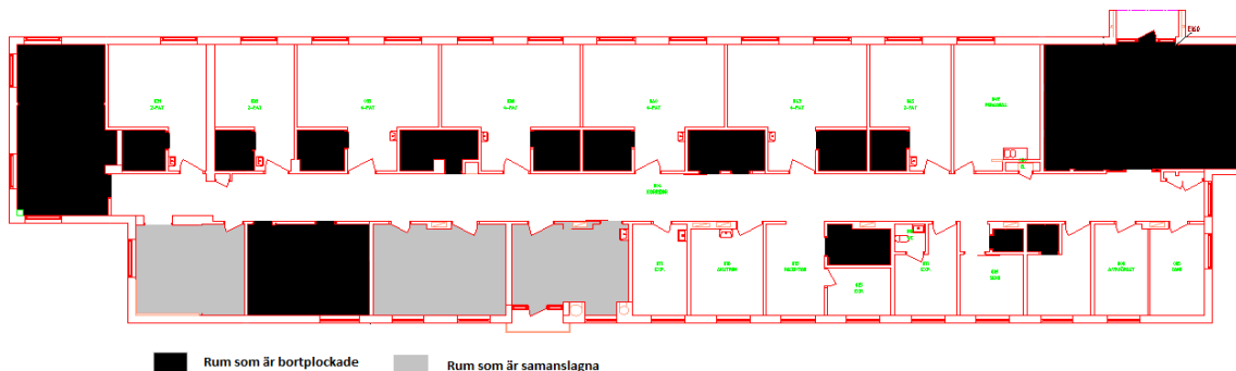
Figur D1 Förenklingar gjorda i geometrin för att ta hänsyn till begränsningar i det använda programmet CFAST.
