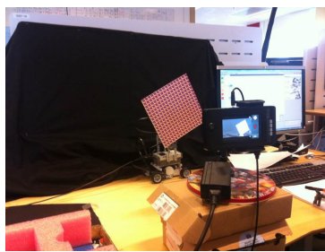
Figur 1: Vår testuppställning med en robot som kör fram och tillbaka med en roterande testbild.
