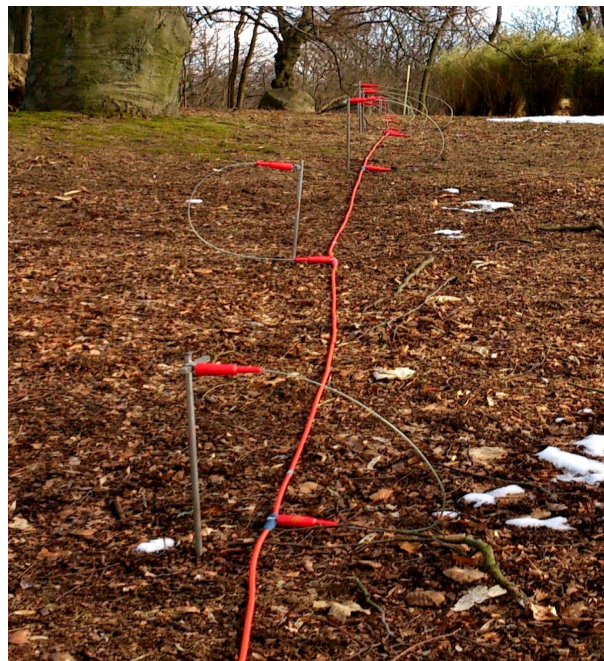
Figur 5. Utlägg med multiledarkabel, i marken nedstuckna elektroder som kopplas samman med jumpers och multiledarkabeln.
