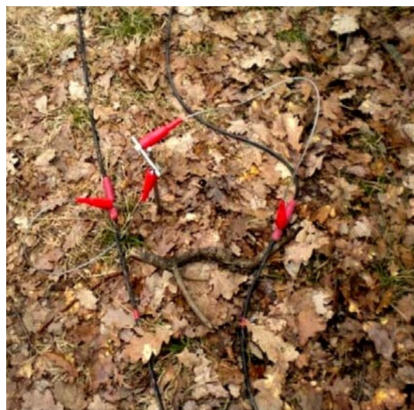
Figur 6. Vid kabelskarvarna kopplas första och sista elektroduttaget ihop till en gemensam elektrod (Jeppsson & Dahlin, 2013).
