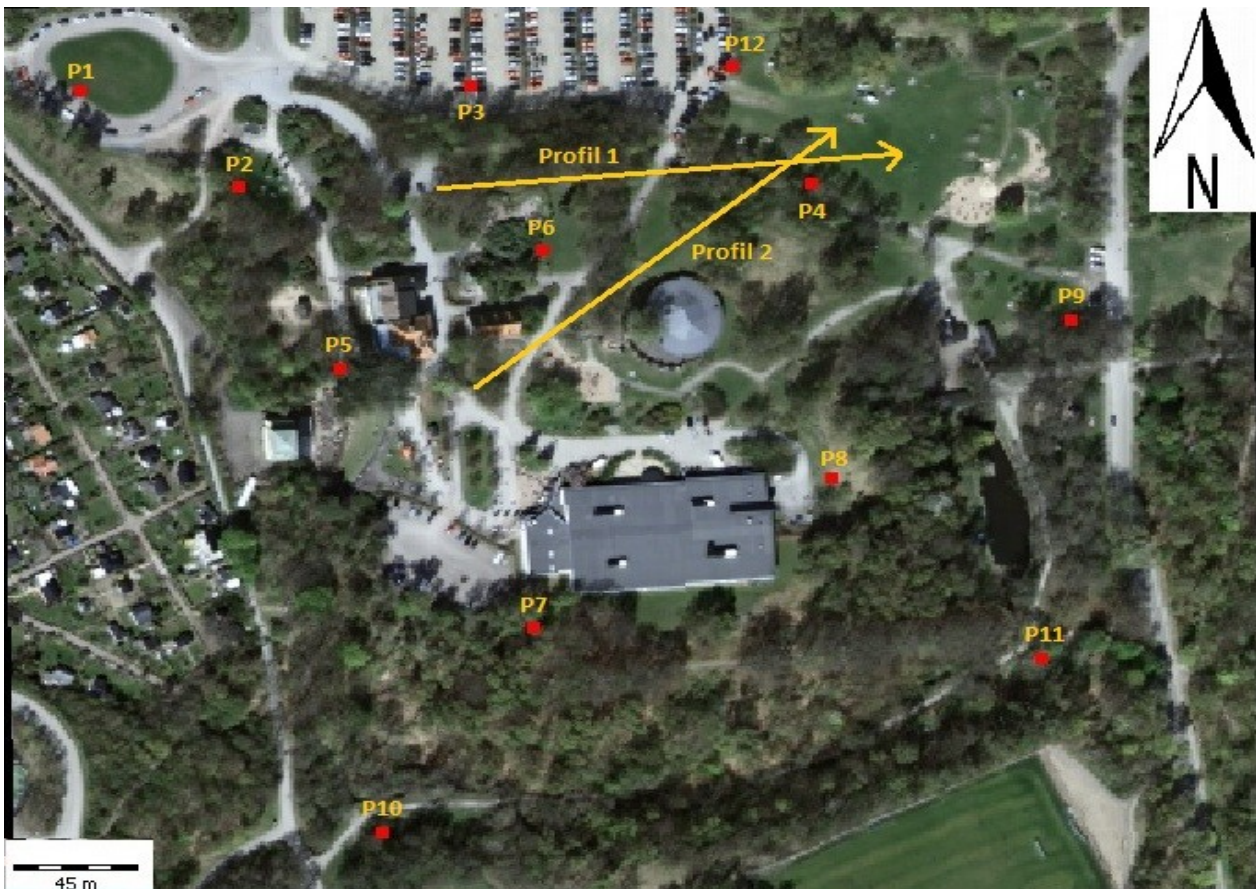
Figur 10. Karta över Sjöcrona Park med utmärkta geofysiska mätprofiler (160 meter långa) och geotekniska borrpunkter 12 stycken utmärkta med röd fyrkant och numrering. (bakgrundskarta från Lantmäteriet [i2012/927]).
