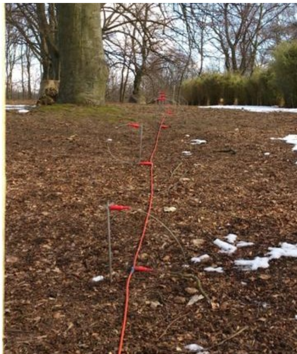
Fig. 9: Elektroder nedstuckna i marken kopplades in till elektroduttagen på multiledarkablarna med jumpers. Foto: Robin Kihlén.
