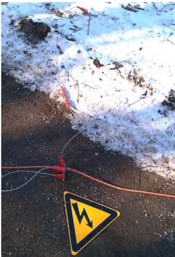
Fig. 12: Tjälän i marken gjorde att elektrodkontakten ibland blev dålig. Detta åtgärdades med blötning av elektroderna och i vissa fall även genom användning av multipla elektroder. På bilden två multipla elektroder ihopkopplade med jumpers. Foto: Wictor Linders.
