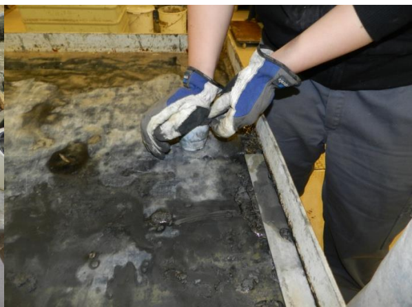
Figur 3: Jag pressar ner blandningarna i muggarna på ett skakbord.
