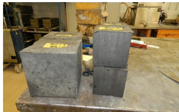
Några block "askbetong" från undersökningen.
