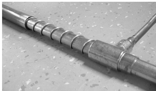
Figur 3 Konstruktionen för koaxialrörvärmväxlaren som används i Askos HWC-tvätt- och diskmaskiner. På bilden är det yttre röret delvis borttaget. Processvattnet flödar till maskinen från höger till vänster i det inre röret i bilden och värmevattnet från vänster till höger i det yttre röret. Det lilla röret som är vinkelrätt mot värmväxlaren är värmevattenreturledningen. [30]
