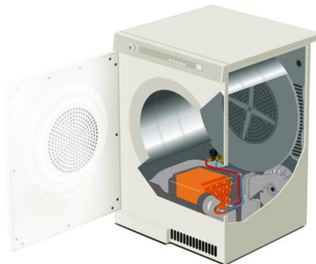
Figur 6 Askos HWC-torktumlare där det orangefärgade området är värmeväxlaren. Det röda representerar ingående värmevatten och det blåa utgående värmevatten. [54]
