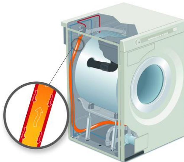
Figur 5 Askos HWC-tvättmaskin där det orangefärgade röret är koaxialrörvärmväxlaren. Det röda representerar ingående värmevatten och det blåa utgående värmevatten. I den uppförstorade bilden syns det hur ingående värmevatten värmer upp ingående kallvatten. [54]
