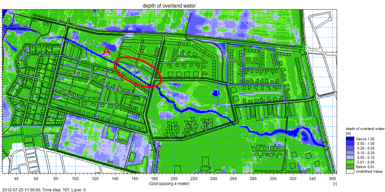
Figur 46. Säbybäckens meandrande utformning i samband med 100-årsregn. Figuren visar bäcken två timmar efter regnets maxintensitet med inkluderad minlösning. Markeringen visar en lokal sänka där vatten i samlas vid extremregn.
