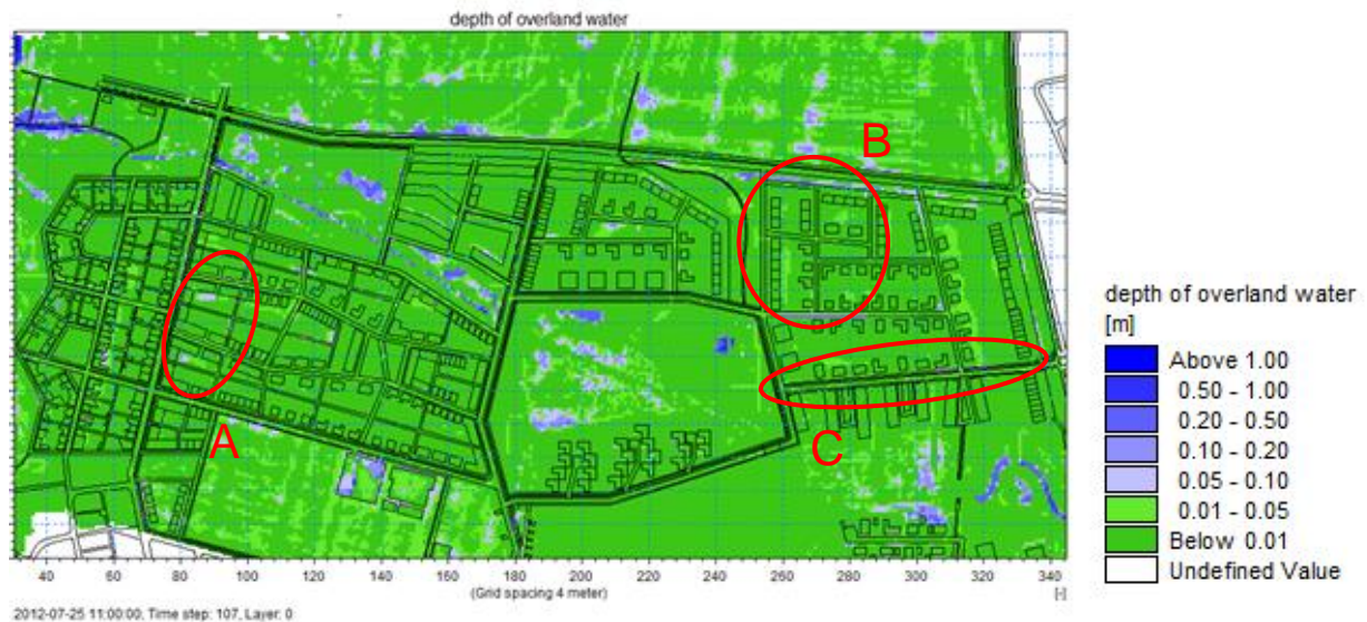
Figur 29. Maxlösningen två timmar efter 10-årsregnets maxintensitet. Maxlösningen är dimensionerad för ett 100-årsregn och avleder därför ett 10-årsregn väl. Markeringar i figuren beskrivs nedan.
