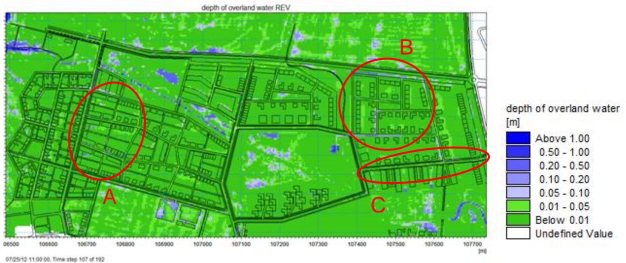
Figur 30. Minlösningen två timmar efter 10-årsregnets maxintensitet. Som syns i figuren avleds vatten väl från vägar och byggnader. Markeringar i figuren beskrivs nedan.
