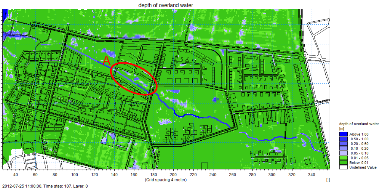
Figur 45. Säbybäckens meandrande utformning i samband med 10-årsregn. Figuren visar bäcken två timmar efter regnets maxintensitet med inkluderad minlösning. Markeringen visar en lokal sänka där vatten i samlas vid extremregn.
