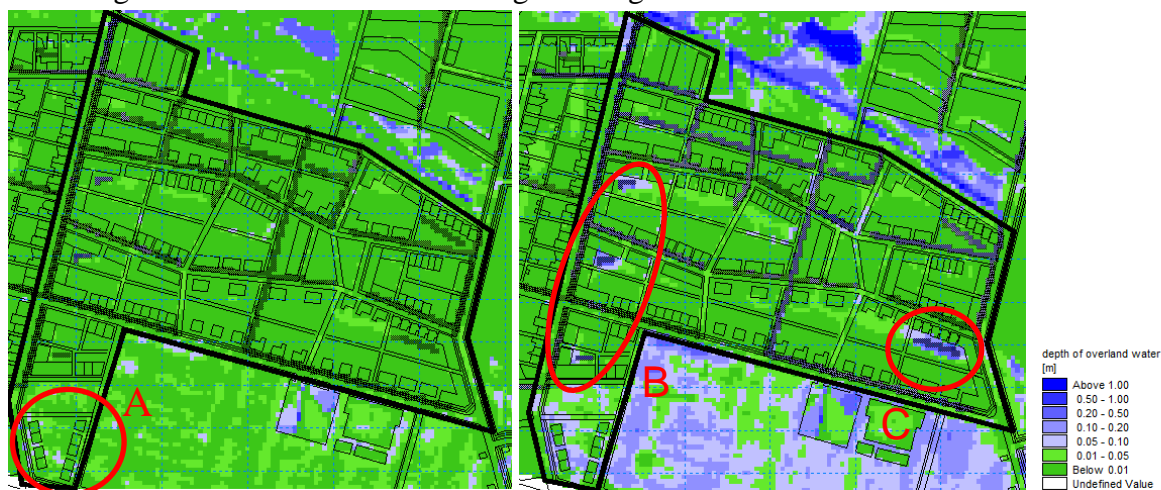
Figur 35. Resultat område 2, området avgränsas med svart markering. Vänster bild visar minlösning med 10-årsregn och höger med 100-årsregn. Svackdiken visas som skuggade områden och röda markeringar beskrivs i nedan.
