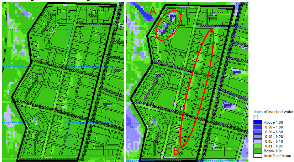
Figur 32. Resultat område 1, området avgränsas med svart markering. Vänster bild visar minlösning med 10-årsregn och höger med 100-årsregn. Svackdiken visas som skuggade områden och röda markeringar beskrivs i nedan.
