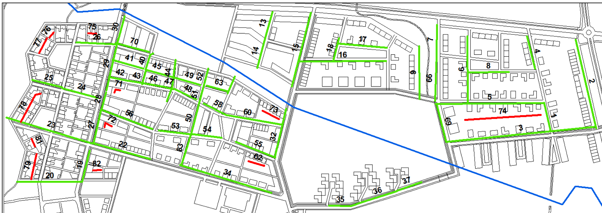
Figur 41. Svackdikens placering i minlösningen där ID-nummer är placerade för att kunna matcha svackdiket med tabell 6 och 7. Svackdiken i grön färg visar svackdiken intill vägar och röda linjer visar svackdiken på tomtmark.
