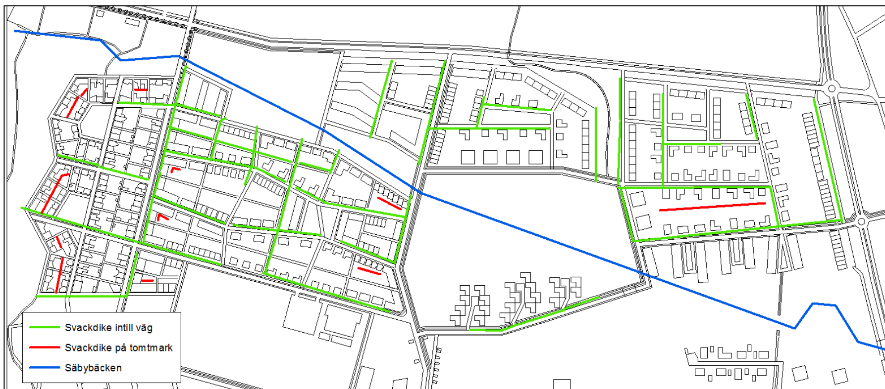
Figur 27. Minlösning av svackdiken i undersökningsområdet. Gröna linjer visar svackdiken vid vägbanor och röda visar svackdiken på tomtmark.
