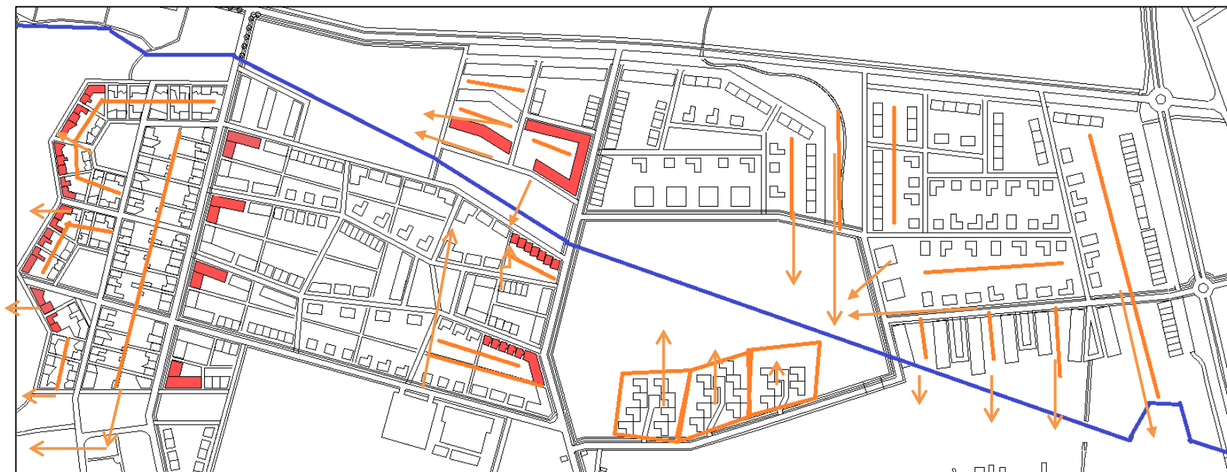
Figur 39. Sammanställning av resultat från detaljstudie av minlösning. Byggnader ifyllda med rött visar de byggnader som har visat sig vara särskilt översvämningsutsatta vid modelleringen. Orange pilar visar på områden där hänsyn bör tas till höjdsättning för att undvika vatten stående på närliggande vägar eller mot byggnader i kombination med minlösningen. Pilarna visar den riktning vattnet kan ta sig till recipienten.
