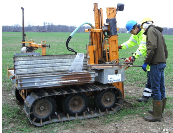
Figur 8. Borring samt sondering utfördes med borrhindvagn i fyra punkter på undersökningsområdet. (Foto Anna Månsson).
