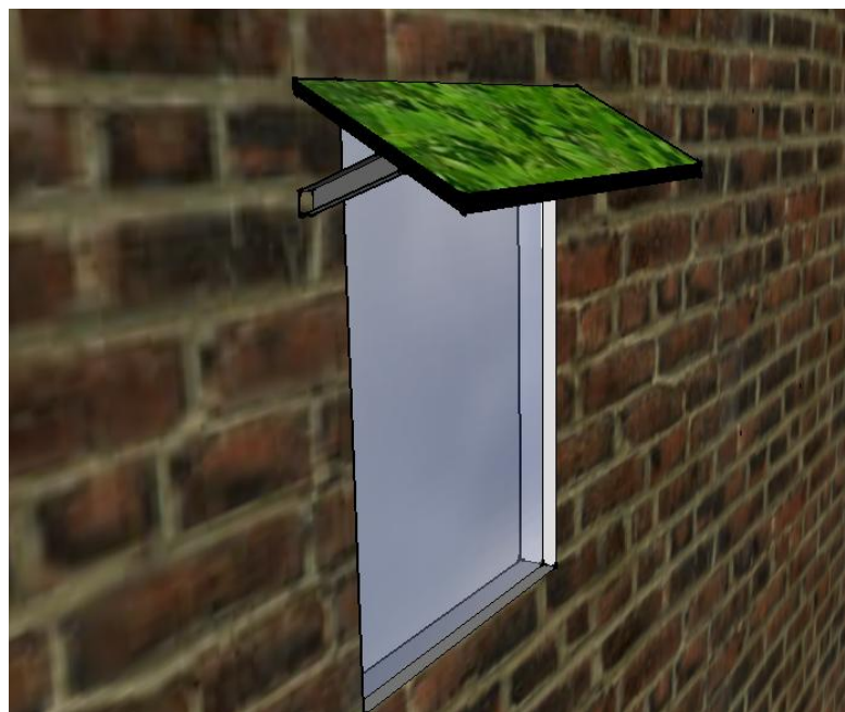
Figur 15: Visuellt tillämpning av växtväggar som solavskärmning. Källa: Emilia Nilsson
