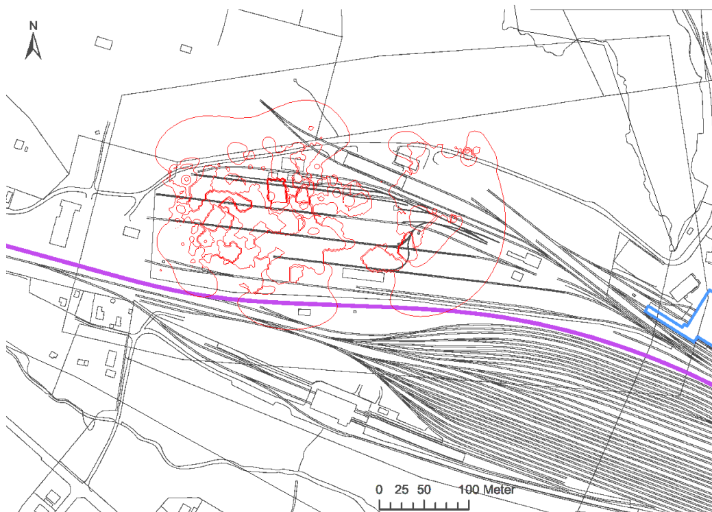
Figur 8-16 Simulering i Microfem. Avsänkning vid schaktning av område V, avståndet mellan isolinjer är 0,5 meter. Jönköpingsbanan är markerad i lila och tvätthallen i blått. Kartområde O1, se Figur 2-1.
