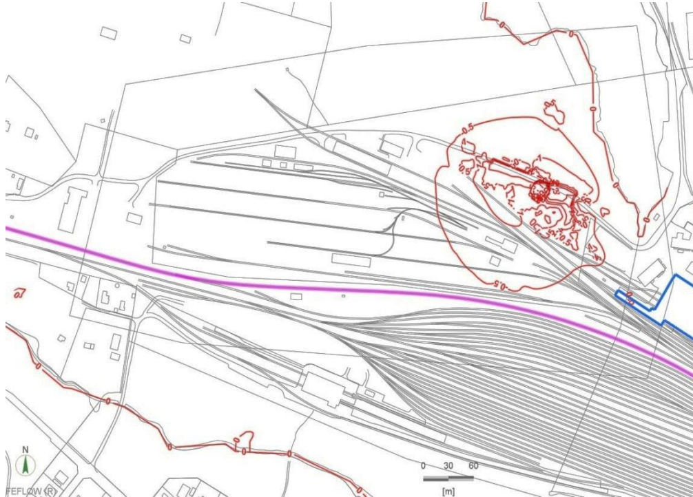
Figur 8-9 Simulering i Feflow. Avsänkning vid schaktning av område II, avståndet mellan isolinjer är 0,5 meter. Jönköpingsbanan är markerad i lila och tvätthallen i blått. Kartområde O1, se Figur 2-1.
