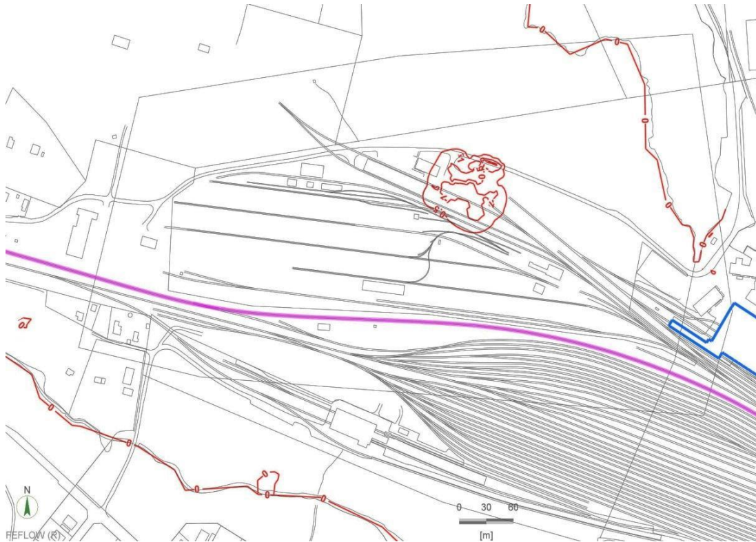
Figur 8-13 Simulering i Feflow. Avsänkning vid schaktning av område IV, avståndet mellan isolinjer är 0,5 meter. Jönköpingsbanan är markerad i lila och tvätthallen i blått. Kartområde O1, se Figur 2-1.
