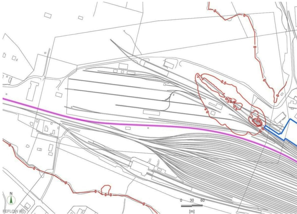
Figur 8-7 Simulering i Feflow. Avsänkning vid schaktning av område I, avståndet mellan isolinjer är 0,5 meter. Jönköpingsbanan är markerad i lila och tvätthallen i blått. Kartområde O1, se Figur 2-1 .
