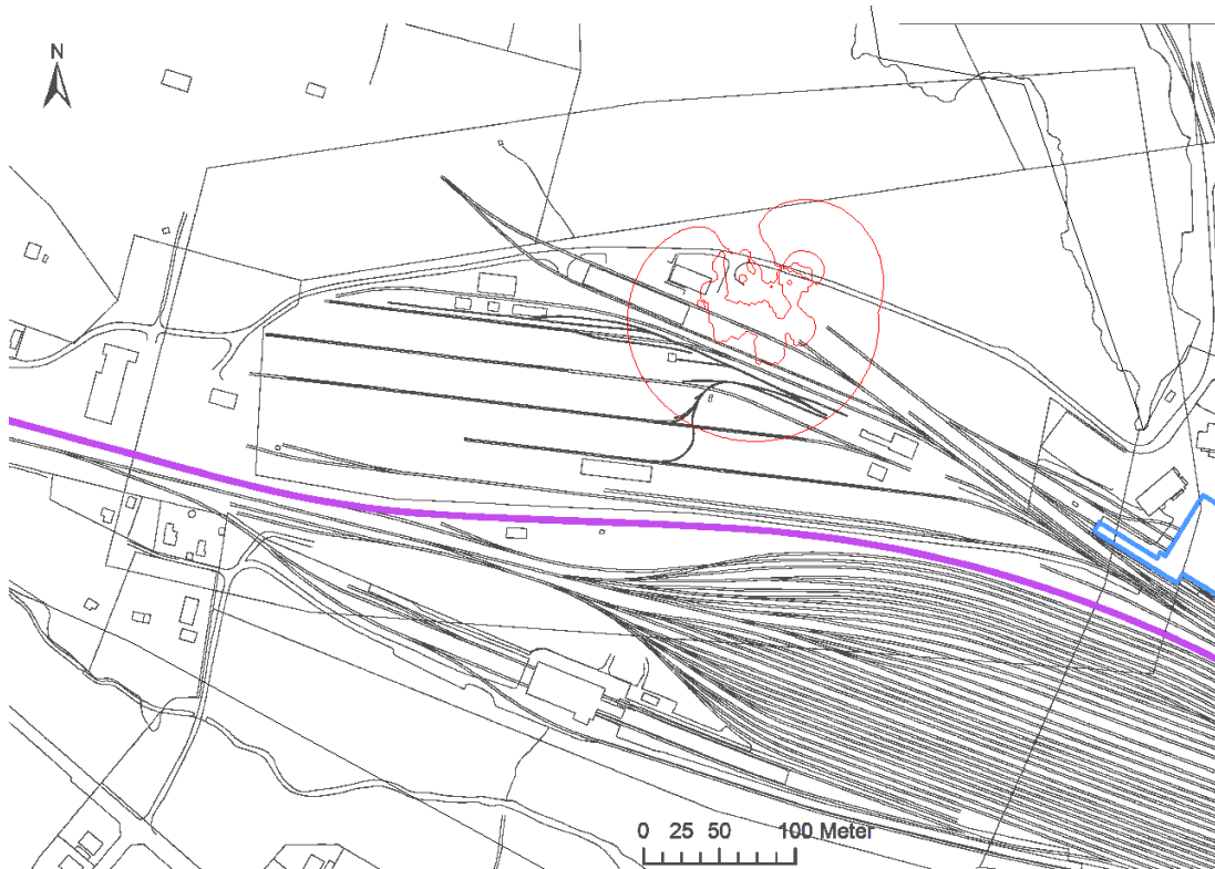
Figur 8-14 Simulering i Microfem. Avsänkning vid schaktning av område IV, avståndet mellan isolinjer är 0,5 meter. Jönköpingsbanan är markerad i lila och tvätthallen i blått. Kartområde O1, se Figur 2-1.
