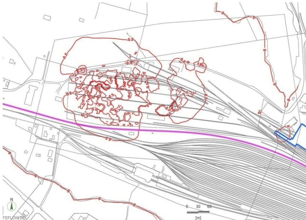
Figur 8-15 Simulering i Feflow. Avsänkning vid schaktning av område V, avståndet mellan isolinjer är 0,5 meter. Jönköpingsbanan är markerad i lila och tvätthallen i blått. Kartområde O1, se Figur 2-1.
