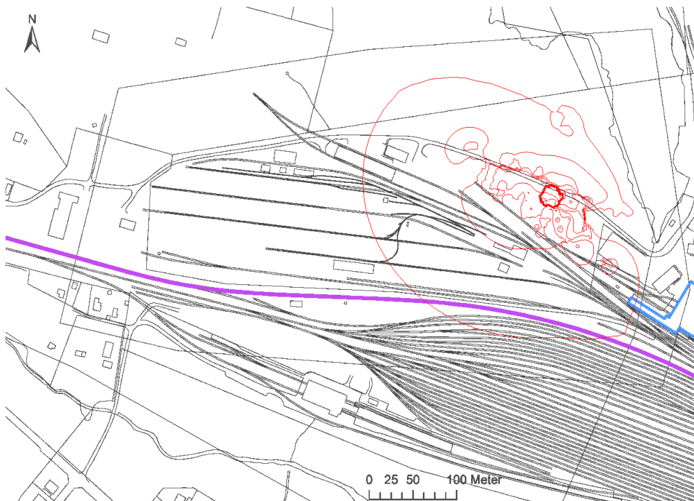
Figur 8-10 Simulering i Microfem. Avsänkning vid schaktning av område II, avståndet mellan isolinjer är 0,5 meter. Jönköpingsbanan är markerad i lila och tvätthallen i blått. Kartområde O1, se Figur 2-1.
