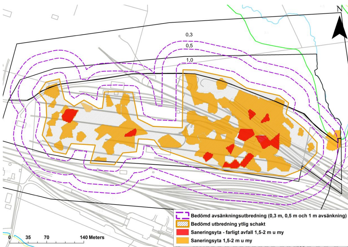
Figur 8-5 Bedömd grundvattenavsänkning tidigare utredning (Tyréns AB, 2012a) för en ytlig, övergripande schakt. Bilden är hämtad från Tyréns (2012a).
