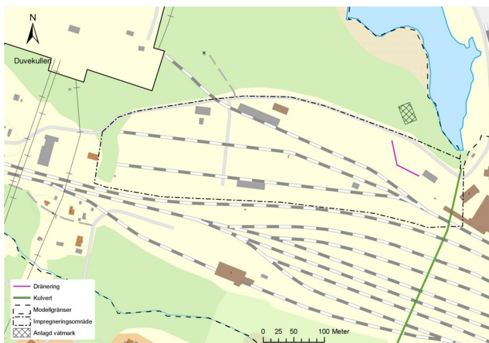
Figur 5-4 Orienteringskarta för impregneringsområdet med dräneringsledning, kulvert, modellgränser, impregneringsområde och infiltrationsanläggning. Kartområde O2 se Figur 2-1, bakgrundskarta © Lantmäteriet i2012/927.
