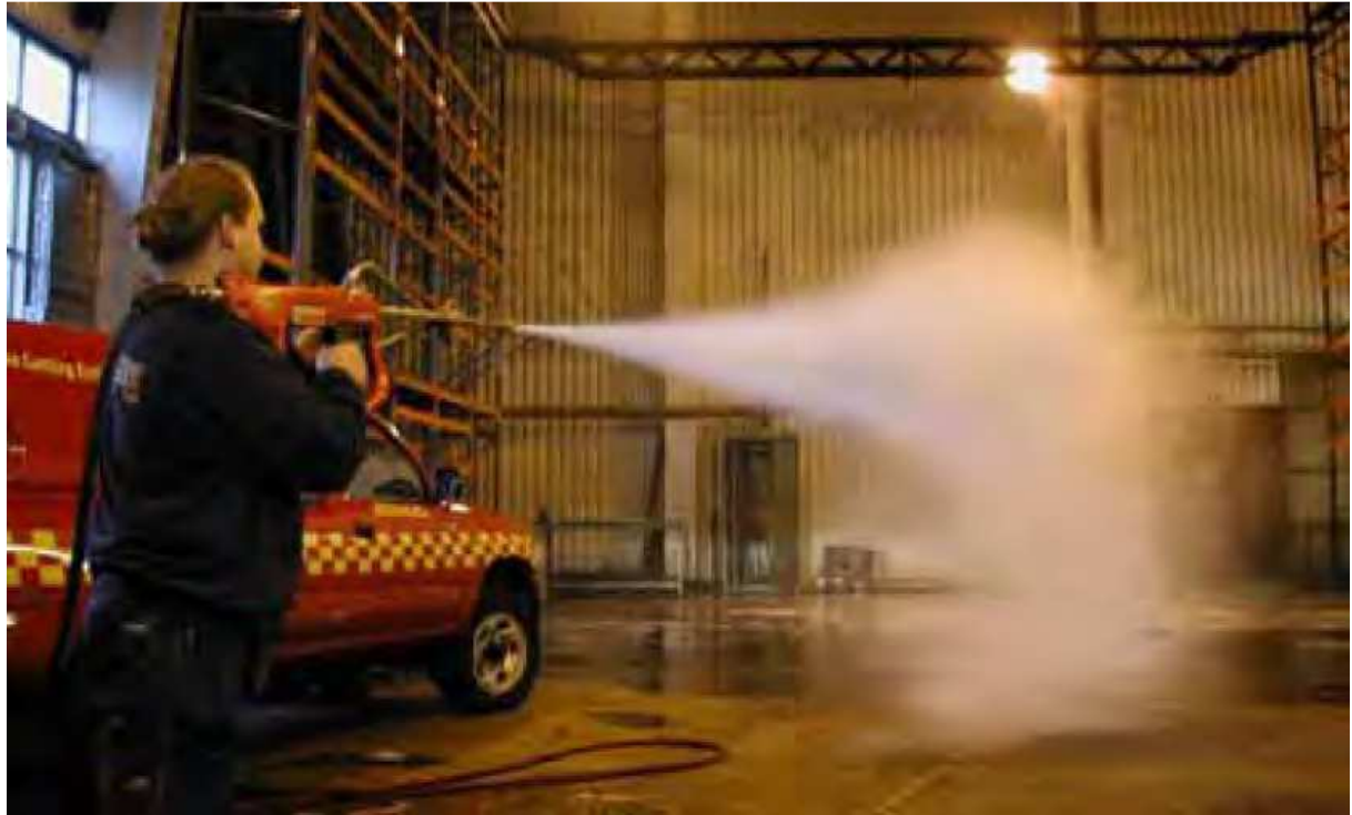
Figure 9. A Cutting Extinguisher's spray pattern (Skärsläckarkonceptets operativa användande, 2010)
