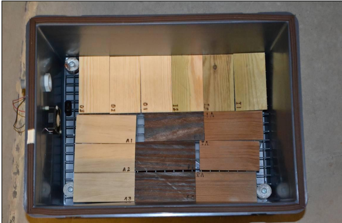
Figur 12. Klimatbox med 15 provkroppar som ligger på galler som håller upp dem från behållarna med saltlösningar.
