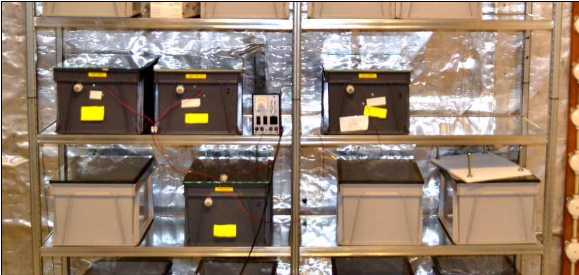
Figur 13. Klimatboxarna i undersökningen placerades i ett klimatrum med 25 °C. Varje klimatbox kopplades till ett aggregat som drev fläkten i boxen.
