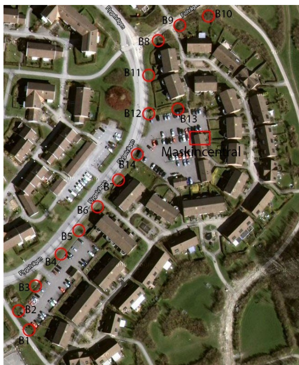
Figur 1. Lokalisering av de 14 brunnarna i Brf Mandolinen längs med Flygelvägen och in mot soprummet (B13). 13 brunnar är borrade av Malmbergs och B14 är den befintliga undersökningsbrunnen som borrades 2002 av HP borrningar AB. Brunnarna B8, B9 och B10 hamnade utanför tomtmarken. Den röda rektangeln visar vart anläggningens värmecentral finns (Modifierad från Google Maps, 2013).
