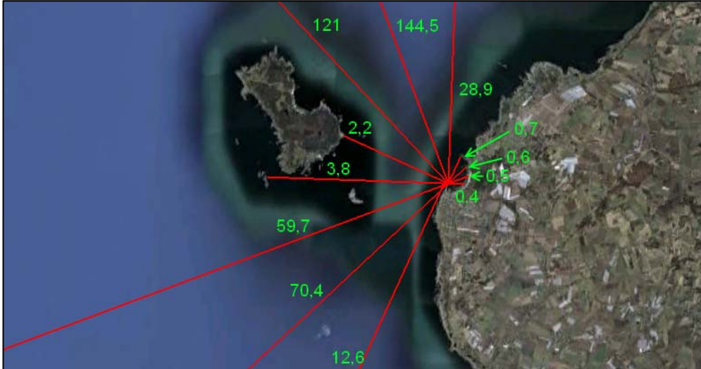
Figur 21 - Visar stryklängderna som använts vid beräkning av våghöjder. De stryklängderna som räknats med är riktningar mellan 202,5° till 90°. Stryklängderna, i kilometer, är utskrivna med grön text. Bilden är tagen från Google Earth 6.0 (2011b).
