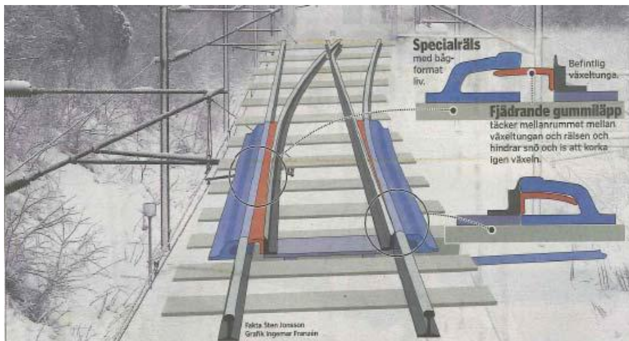
Figur 3.13 Växel med gummiläpp (Kloow, 2011)
